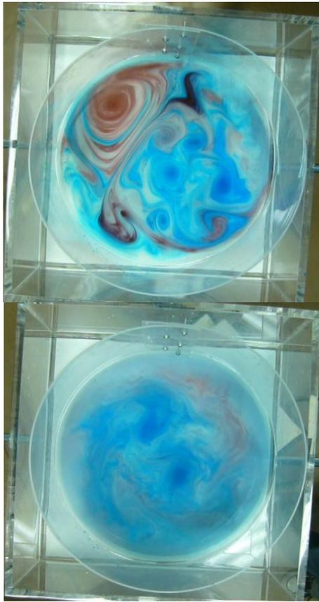
*Fig 3:* a) Tanque con agua y dos indicadores con la mesa rotando. b) Tanque con agua y dos indicadores con el tanque detenido.
